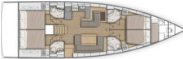
Die Anordnung im Salon bleibt gleich, die Kabinen und Bäder im Achterschiff sind wie bei 3-Kabinen-Version mit 3 Bädern angeordnet. Vorschiff: 2 Kabinen jeweils mit eigenem Bad.
