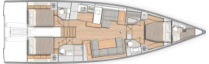
Diese Nasszelle befindet sich zwischen Pantry und BB-Heckkabine: Einzel-Kleiderschrank, ausstellbares Rumpfenster in der Heckkabine
