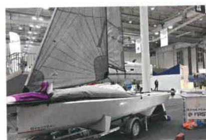
hat die First 18 Zugang zu jedem Strand und Hafen. Nicht zuletzt auch durch den leichten Carbon-Mast, lässt sich das Boot problemlos Trailern. Das Gesamtgewicht beträgt lediglich 500 Kilogramm. Mit einem minimalen Tiefgang von 15 Zentimetern ist es möglich auch an die entlegensten Stellen einer Bucht zu gelangen. Durch eine großzügig geschnittene Kabine zum Schlafen, Essen und Wohnen steht dem Leben an Bord nichts im Weg. Das Erkunden von Küsten und Nationalparks wird so
